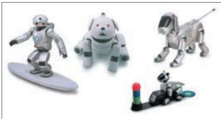
FIGURA 4 Alcune generazioni di robot giocattolo Sony. A sinistra l'umanoide SDR-4X: 38 gradi di libertà, riflesso di autoprotezione in caso di caduta, 2 videocamere e 7 microfoni
