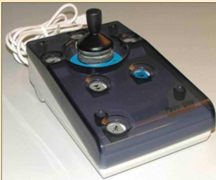
FIGURA 1 Joystick con scudo in plexiglass (Ufficio H della Comunità Piergiorgio di Udine www.piergiorgio.org )
