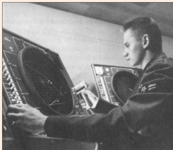
Consolle di comando dello AN/FSQ-7. Si noti la light-gun nella mano dell'operatore
