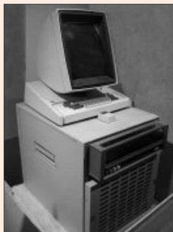
Lo Xerox Alto. La tastiera è estraibile. Si noti il mouse a tre tasti
