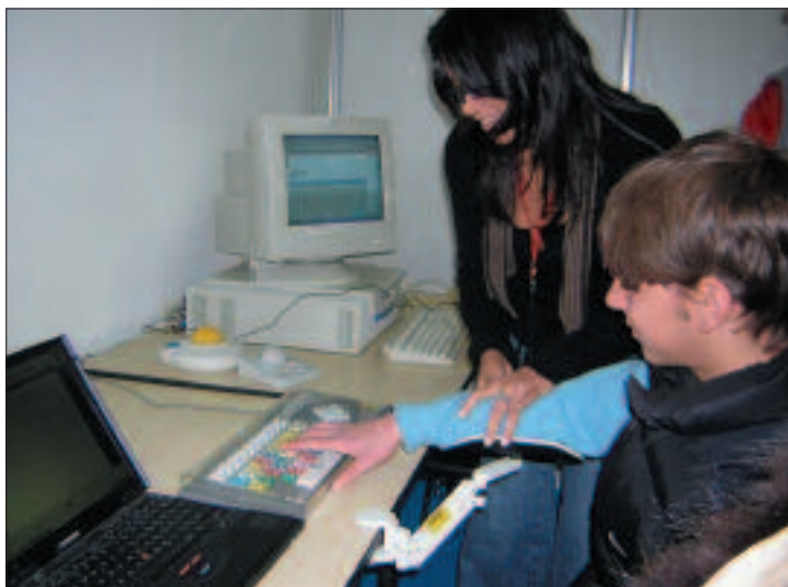
FIGURA 5 Tastiera con scudo, per consentirne l'utilizzo per esempio a persone spastiche
